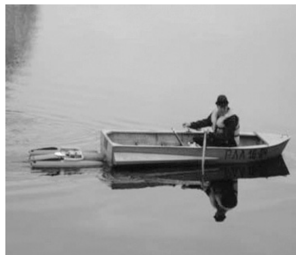
Измерение расхода воды с помощью профилографа (07 мая 2015 г.) на р. Луге
