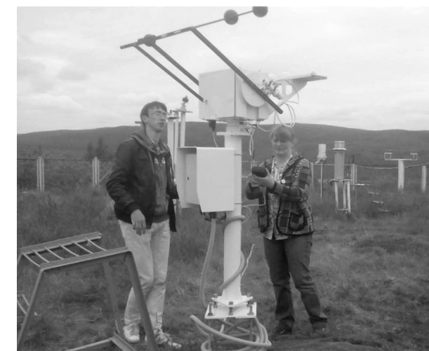
Настройка актинометрического измерительного комплекса на ГМС Мурманск
